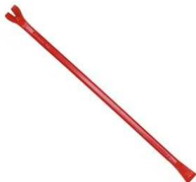
Il y a deux sortes de pinces : la grande et la petite. La grande pince sert à faire des trouées dans un plancher, à soulever les plaques d'égouts, etc... Elle se compose d'une tige, d'un biseau et d'un pied de biche. La petite pince, semblable à la grande mais de dimension plus petite, sert à forcer une porte par exemple, à gratter des pièces de bois atteintes par le feu...elle est portée en bandoulière dans une gaine en cuir.
