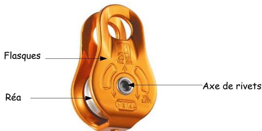
Bien observer les flasques, réa et axe de rivets, aussi bien à l'intérieur qu'à l'extérieur pour détecter toutes déformations, fissures, marques d'usure et de corrosion. Rechercher leur origine : outils coupants, chocs...
