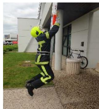
L'équipier teste la solidité du point d'appui en se suspendant à l'échelle.
