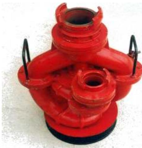
L'eau en pression, qui arrive par le tuyau de 70, met en mouvement la turbine et se dirige ensuite vers le collecteur central d'évacuation. La turbine fait tourner la pompe centrifuge montée sur le même axe. L'eau à évacuer traverse la crépine puis, du centre de la pompe, est chassée à l'extérieur, remonte dans le collecteur latéral pour rejoindre l'eau d'alimentation dans le collecteur central d'évacuation sur lequel est branché un établissement de tuyaux de 110.
