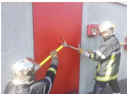
Réaliser un ou plusieurs trous rapprochés en frappant le pointeau au milieu de la porte.
