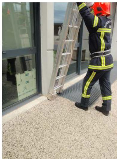
Le sapeur-pompier détache la corde, redresse l'échelle, déverrouille les parachutes en tirant sur la corde.
