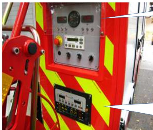
Tableau de commande de la pompe avec régulation automatique de pompe
