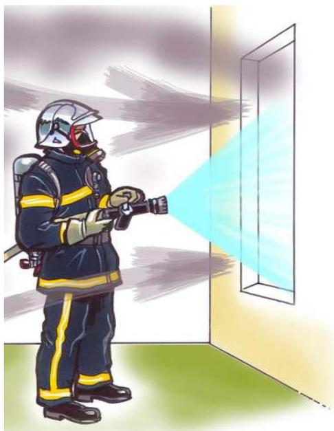
En projetant de l'intérieur du volume un jet diffusé par une ouverture, le passage de l'eau dans cette dernière crée l'aspiration des fumées (effet venturi) et permet une ventilation efficace.
