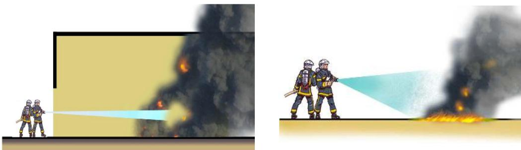
Ces applications sont à mettre en œuvre lorsque l'eau peut être directement posée sur les surfaces combustibles. En attaque intérieure, le jet droit est à privilégier pour maintenir une ambiance thermique la plus tenable possible. En configuration extérieure, le jet droit permettra de gagner en portée (cas du rayonnement important par exemple) ou en efficacité en utilisant un jet diffusé (possibilité d'approcher le foyer).
