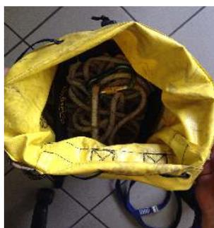
Ranger la corde en vrac au fond du sac (sans la lover pour éviter les nœuds) en terminant avec l'extrémité muni de la protection de corde et du mousqueton à verrouillage automatique.
