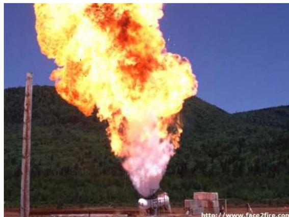
Vaporisation violente à caractère explosif consécutive à la rupture d'un réservoir contenant un liquide à une température significativement supérieure à sa température d'ébullition à la pression atmosphérique.
