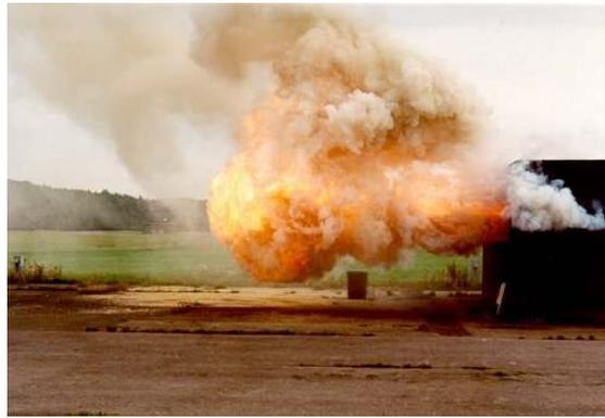
**Fumées surchauffées, accumulées dans un volume clos, explosant lors d'un apport d'air**
